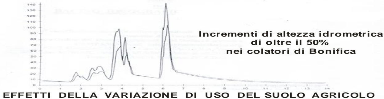
Fig. 9.17 Simulazione del cambiamento di risposta idrologica a seguito di variazione di uso del suolo con incremento dell’area impermeabile fino al 30% della superficie del Bacino riconducibile alla impermeabilizzazione conseguente alla urbanizzazione di terre agricole
